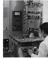
電子顕微鏡によるハロゲン化銀解析(研究所)
