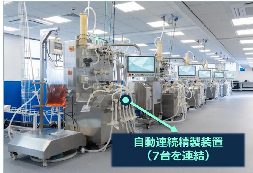
培養槽から連続的に液を引き抜きながら、精製工程も並行稼働し、抗体を連続的に回収する
